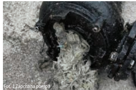
Fot. 1 Zapchana pompa
